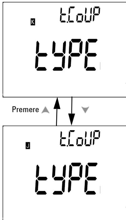
Figura 4-3 Impostazione del tipo di termocoppia
